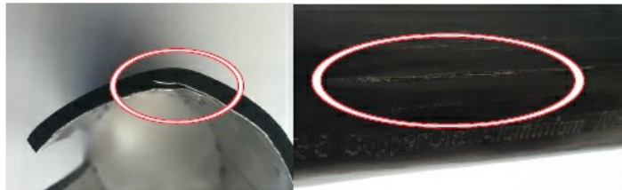
Al-folien har penetrerat in i manteln
